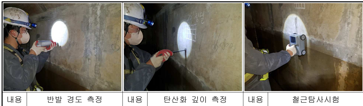
【사진 10.26】 덕이호수 재료시험 전경
